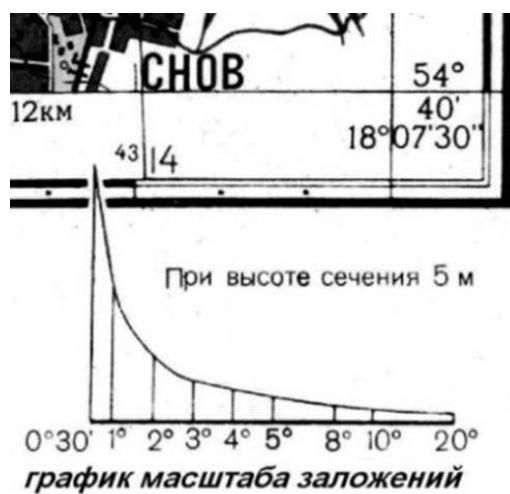
Рисунок 17 – График заложений для углов наклона
