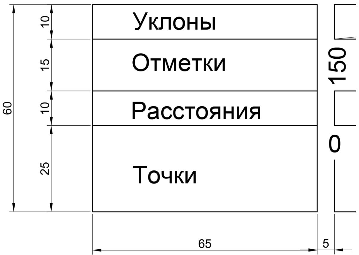
Рисунок 24 – Размеры упрощенного штампа продольного профиля
